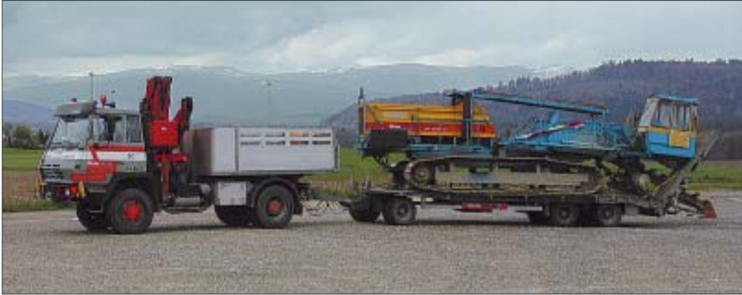
Schwertransporte bis 34 t mit Tiefganganhänger
